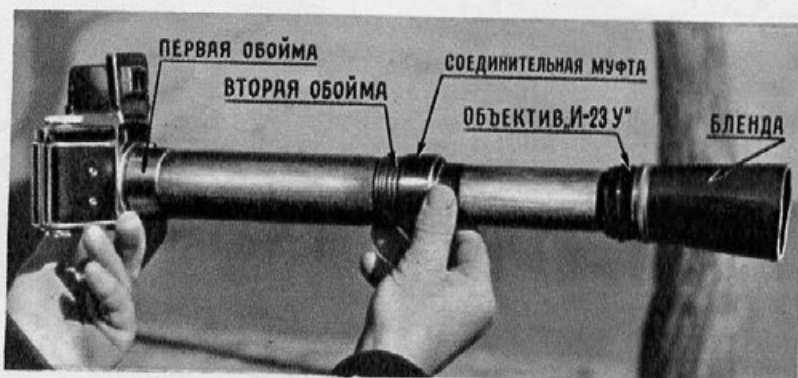
Фото 1. Общий вид аппарата с комбини- рованным объективом
